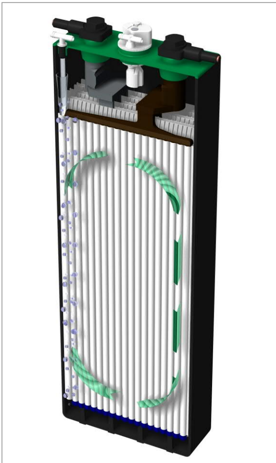
Рис. 5 Принципиальная схема системы циркуляции электролита HOPPECKE trak|air
