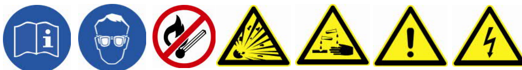
Рис. 6 – Обязательные инструкции и предупреждающие символы на табличках с типом аккумулятора
