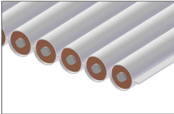
Рис. 2 Схема положительного электрода
